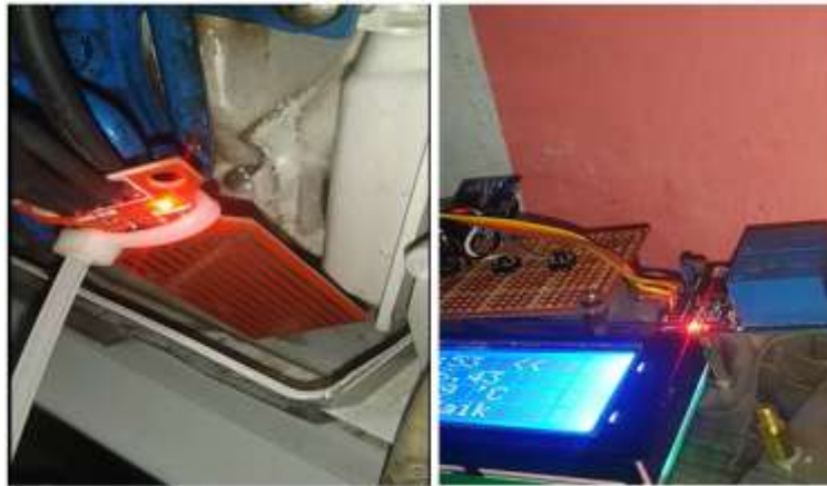
Gambar 11. Percobaan Sensor Water Level Dan Relay Pada Kondisi Kering
